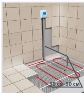
Схема укладки датчика температуры в гофрированной трубке
